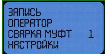
а затем нажмите
